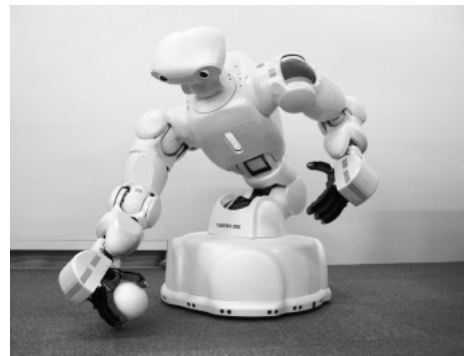
写真 「TWENDY-ONE」は、外見の親和性も重視し、無数の配線を内部に収納できるように設計されている。写真提供：早稲田大創造理工学部菅野重樹研究室
